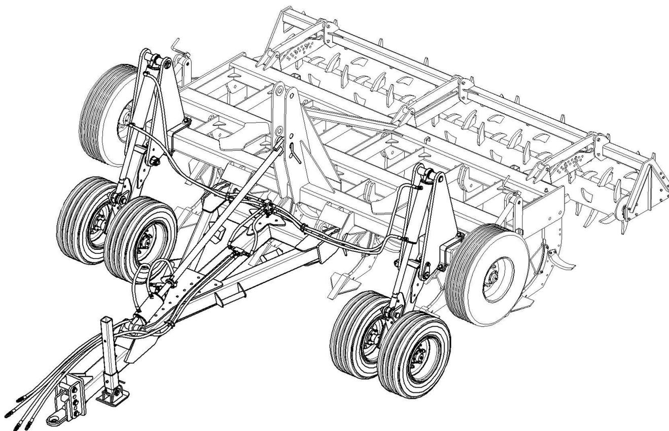
В данном каталоге представлен список запасных частей на ГРП-4.01.01.000 «Оснащение глубокихлителя полуприцепным устройством», выпускаемым ООО «Завод имени Медведева – Машиностроение». Комплект данного оборудования предназначен для установки на навесные глубокихлители ГРП-4 и ГРП-5 с целью переоборудования их в полуприцепные агрегаты.
