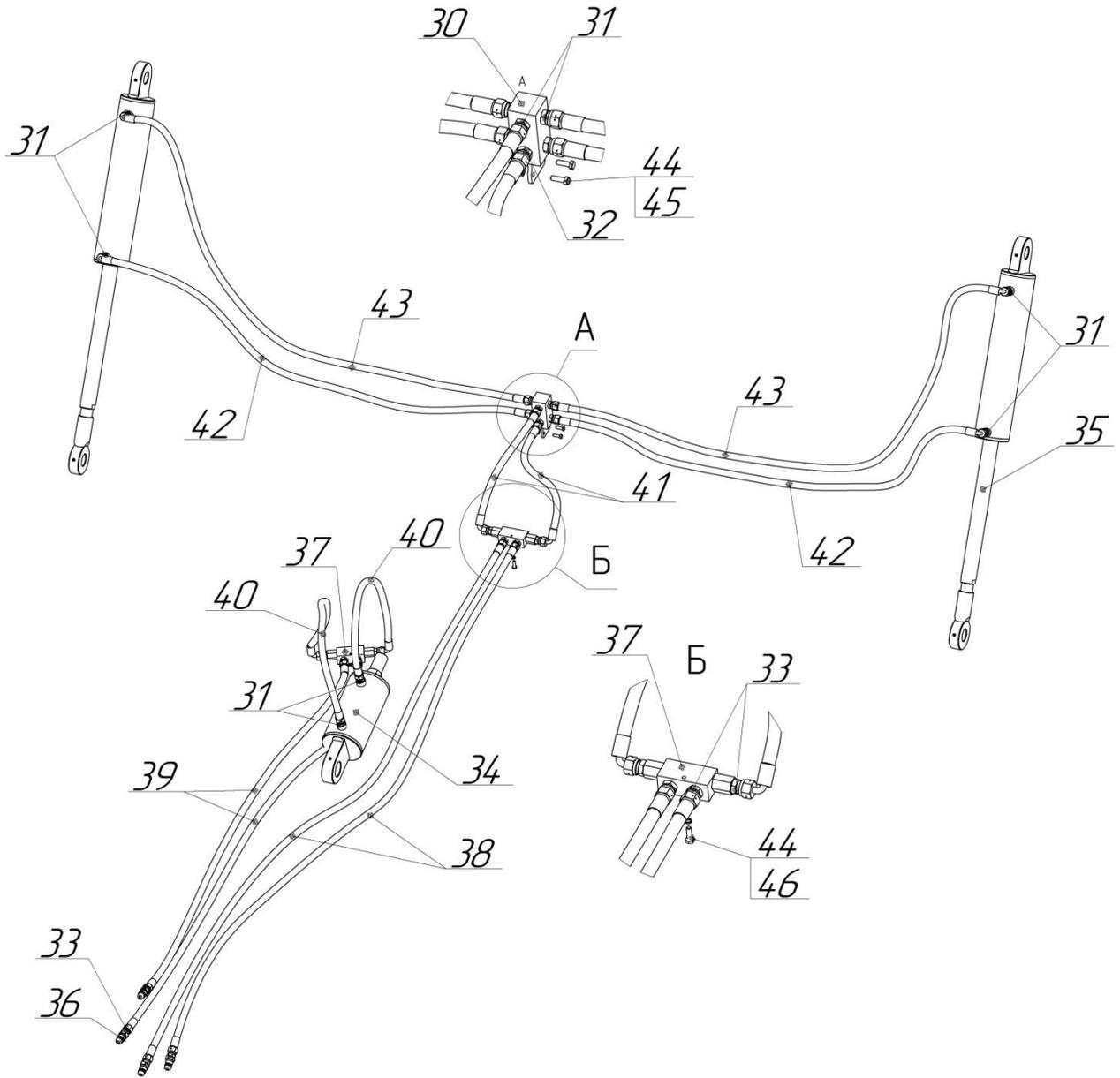
Рисунок 2 ГРП-4-01.01.300 Гидрооборудование.
