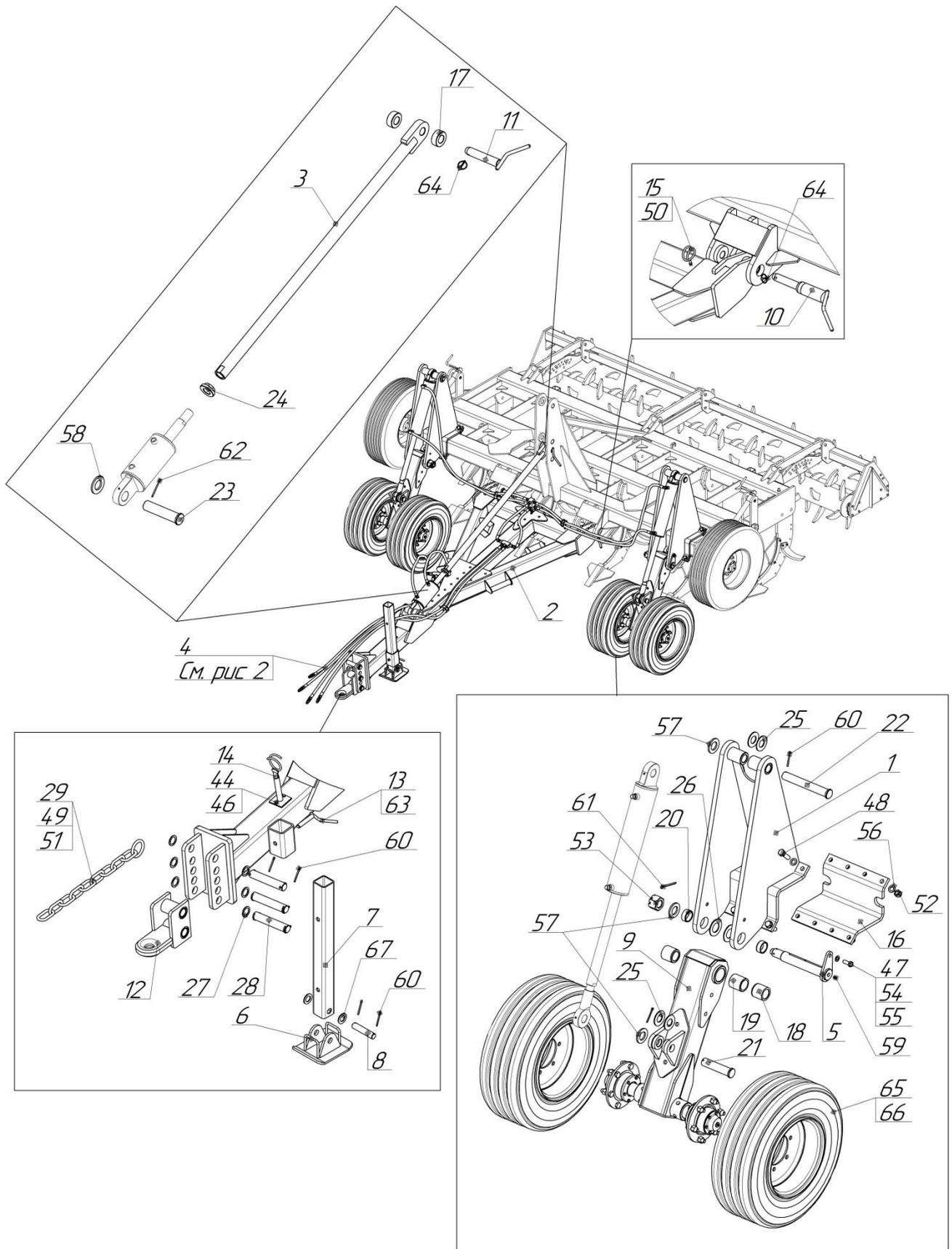
Рисунок 1 ГРП-4-01.01.000 Оснащение глубокорыхлителя прицепным устройством.
