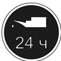
Смазка указанных мест должна производиться один раз в 24 часа. Тип смазки Литол-24 ГОСТ 21150. Нарушение может привести к поломке.
