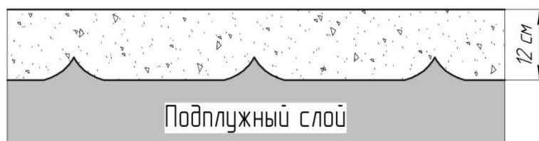
Рисунок 3 – Вид грунта при правильной настройке
